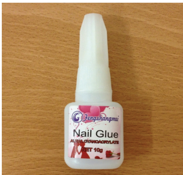
Figura 1. Cola cosmética para unhas. O principal constituinte é o cianoacrilato, um monómero com capacidade de polimerizar em cadeias longas através de pontes, com um grande poder adesivo.
